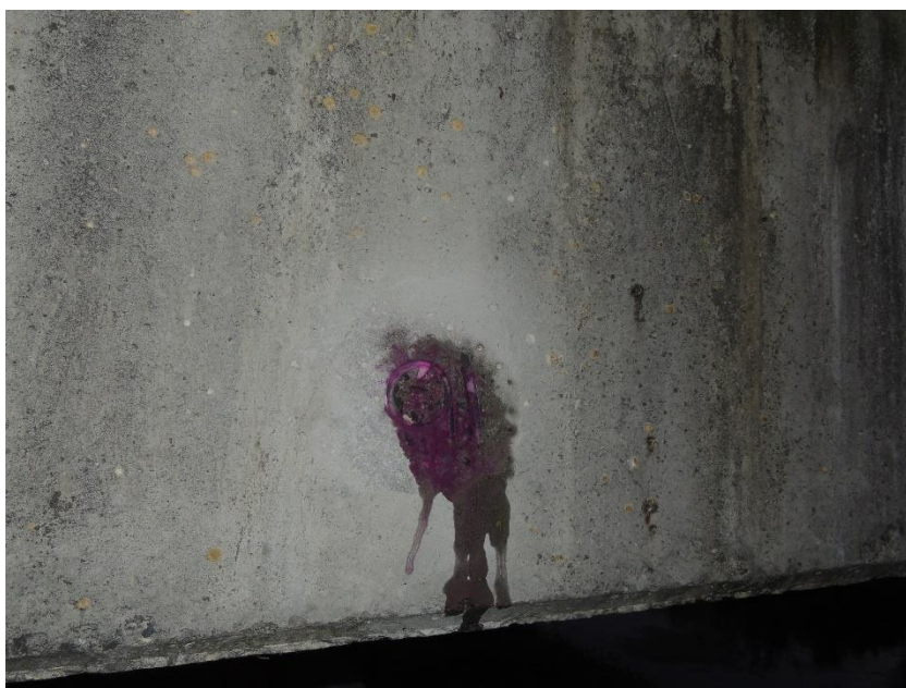
Pohled na zkušební místo po odtržení zkušebního terče a kolorimetrický test karbonatace betonu prefabrikovaného nosníku
