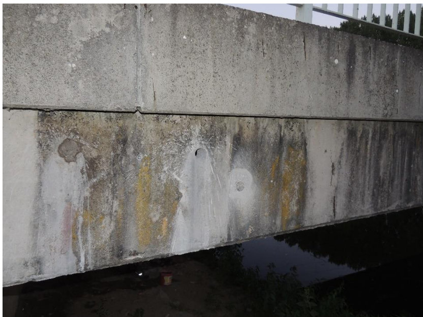
Pohled na zkušební místo pro stanovení soudržnosti povrchových vrstev a nedestruktivní stanovení pevnosti betonu krajního nosníku nosné konstrukce
