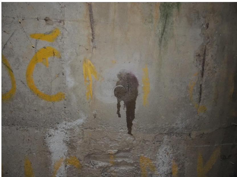
Pohled na zkušební místo po odtržení zkušebního terče a kolorimetrický test karbonatace levé opěry
