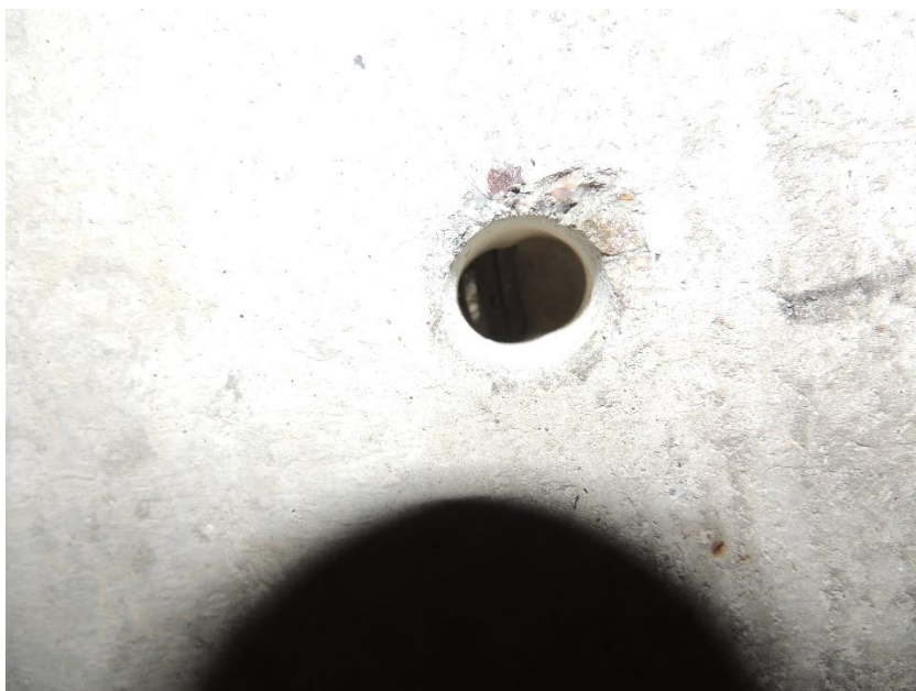
Sonda k předpínací výztuži nosníku levého pole mostu
