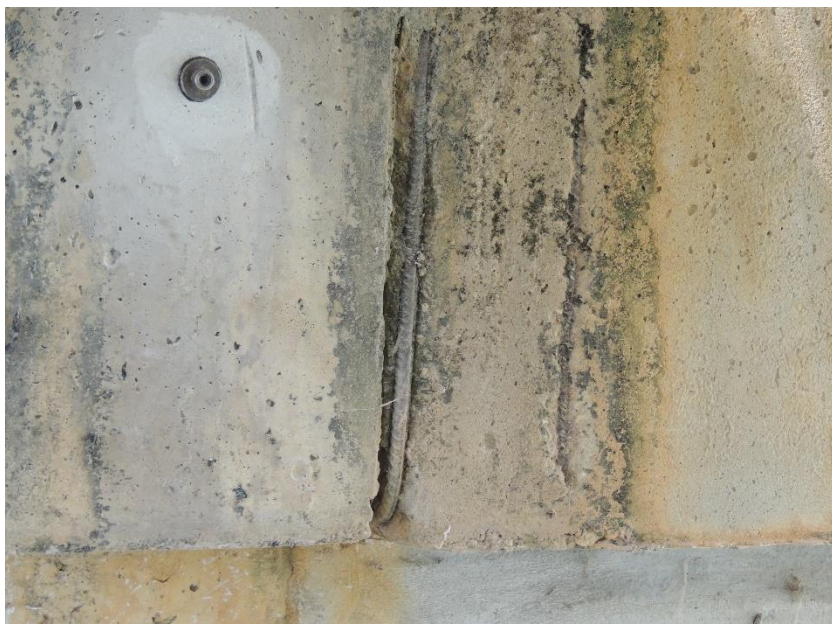
Pohled na zkušební místo pro stanovení soudržnosti povrchových vrstev a nedestruktivní stanovení pevnosti betonu úložného prahu levého pilíře
